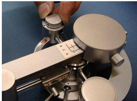
NOTE：アンチスケーティングの調整はレコード再生中でも可能です。レコード内周の溝のない内部でゆっくりとカートリッジが内側に流れる程度が基準です。
