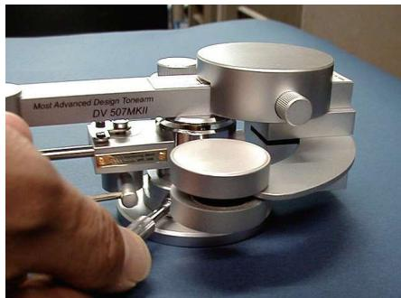
NOTE：高さ調整レバーを固定する時、締めすぎないようにしてください
