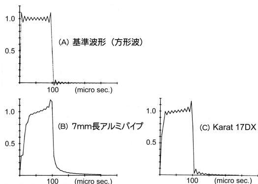
波束分散による波形の変化を、計算によってシミュレートした結果を図1に示します。図(A)は5kHzの方形波を200次までの高調波で表したもので、この波形がカンチレバーに加えられる入力信号とします。図(B)、(C)はカンチレバーを伝搬した後の出力信号に相当します。(B)は従来より使用されている一般的な7mm長のアルミパイプカンチレバー、(C)はKarat 17DXの1.7mm長ダイヤモンドカンチレバーをそれぞれ伝搬した場合の波形で、カートリッジ自体の周波数特性は全く同じと考えてのうえです。Karat 17DXの波束伝搬速度がいかに優れているかがお判りになると思います。
