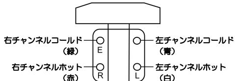
付属のねじを用いてカートリッジをシェルに取り付けます。適合のネジサイズはM2.5です。取り付け位置はご使用のトーンアームのオーバーハングに合わせます。詳しくはトーンアームの取扱説明書を参照ください。
